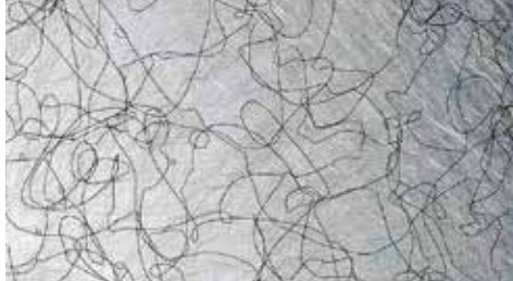
Detail: Verglasung „Efni, grau“ Klarglas mit innenliegendem Gewebestoff
